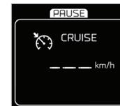
**!** No caso de descida acentuada, o regulador de velocidade não poderá impedir o veículo de ultrapassar a velocidade programada. Em caso de subida acentuada ou de reboque, a velocidade programada poderá não ser atingida ou mantida.
