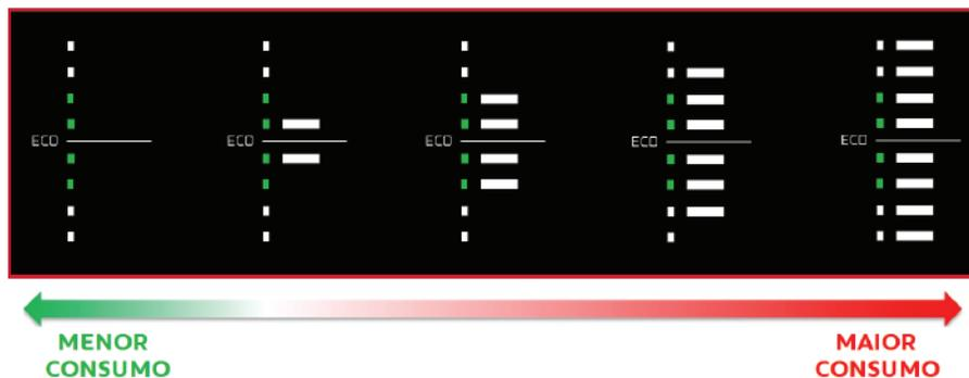
O econômetro é um indicador de consumo de combustível, cuja função é auxiliar o motorista a conduzir o veículo, de maneira mais econômica possível quanto ao consumo de combustível, levando em conta as condições de tráfego e do percurso.
