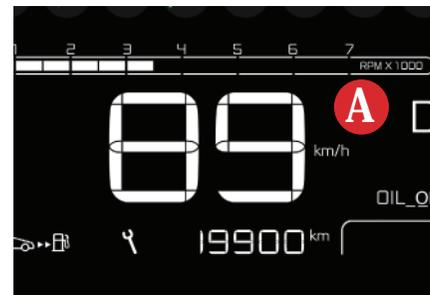
Evite aproximar-se do limite máximo de rotações **A**, para preservar a vida útil do motor. A aproximação do limite máximo de rotações indica a necessidade de engrenar uma marcha superior.
